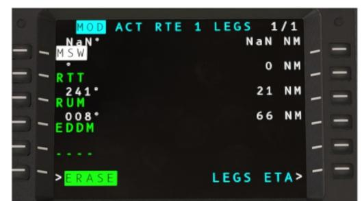
HINWEIS: Verwenden Sie die CLR-Taste, um **DELETE** im Scratchpad anzeigen zu lassen. Sobald DELETE im „Scratchpad“ erscheint, können Sie mittels der LSK auf den zu löschenden Wegpunkt klicken, um diesen aus der Wegpunktseite zu entfernen. Hiermit werden darunter liegende Wegpunkte "nach oben" (move up) verschoben.
