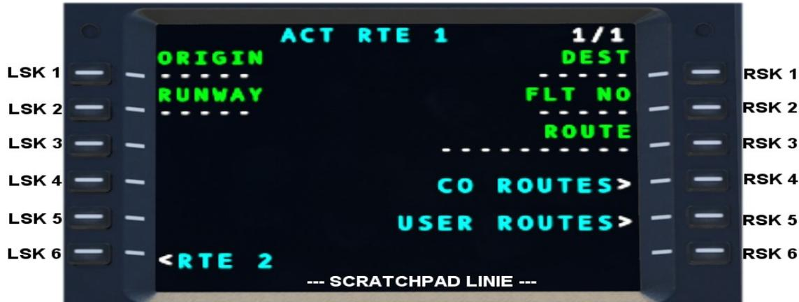
Der auf dem FMS eingegebene Text wird in den Notizblock, die Zeile am unteren Rand des Bildschirms (SCRATCHPAD LINE), eingegeben. Dieser Text kann durch Tippen geändert und dann in ein Feld eingegeben werden, indem Sie die benachbarte Zeilenwahltaste (LSK/RSK) wählen.
